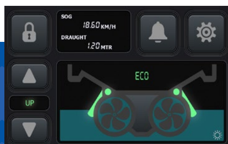
FLEX Tunnel touchscreen besturingspaneel
